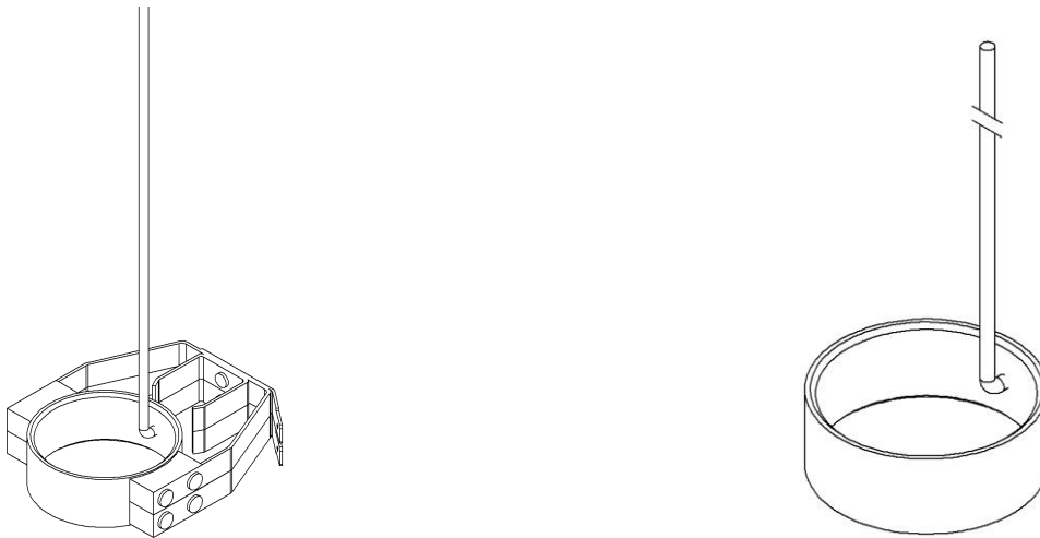
Abb. 14: Typ 45/2 Stromabnehmer mit Schleifring und Litze
