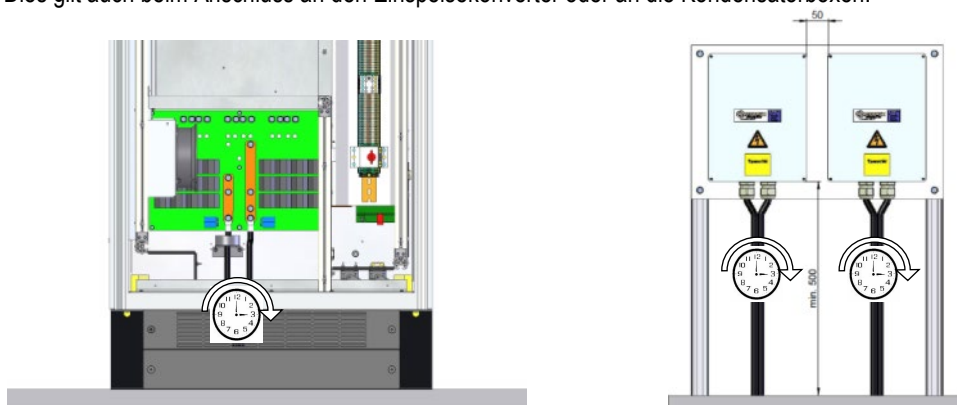
Abbildung 3.11: Litzleitungsorientierung bei Einspeisekonverter und Kondensatorboxen
