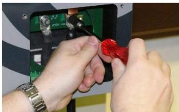
Abb. 18: Anschluss Trackleitung, mit montierter Abdeckplatte Trackleitungen gezeigt
